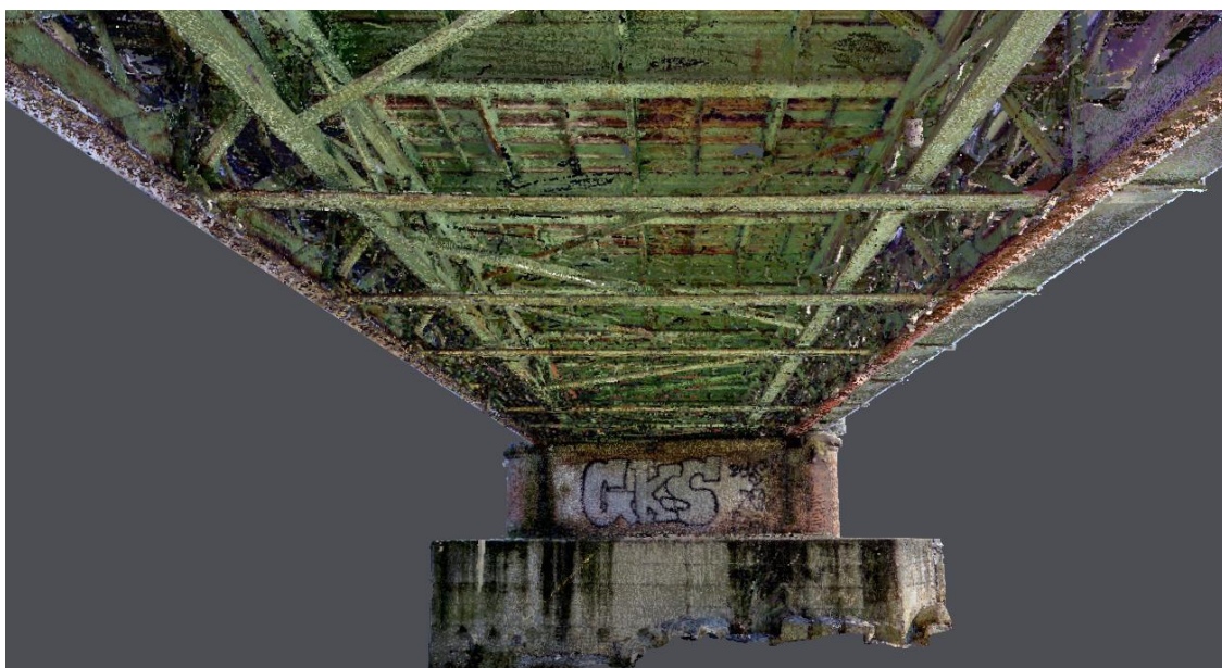
Figura 6-8: Immagine del rilievo 3D. Nuvola di punti
