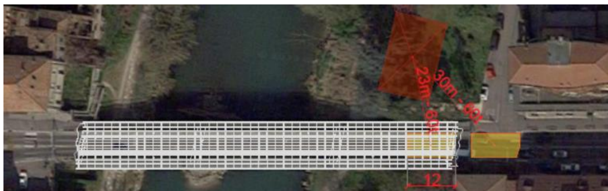
Figura 8-2: Taglio e rimozione prima porzione di impalcato
